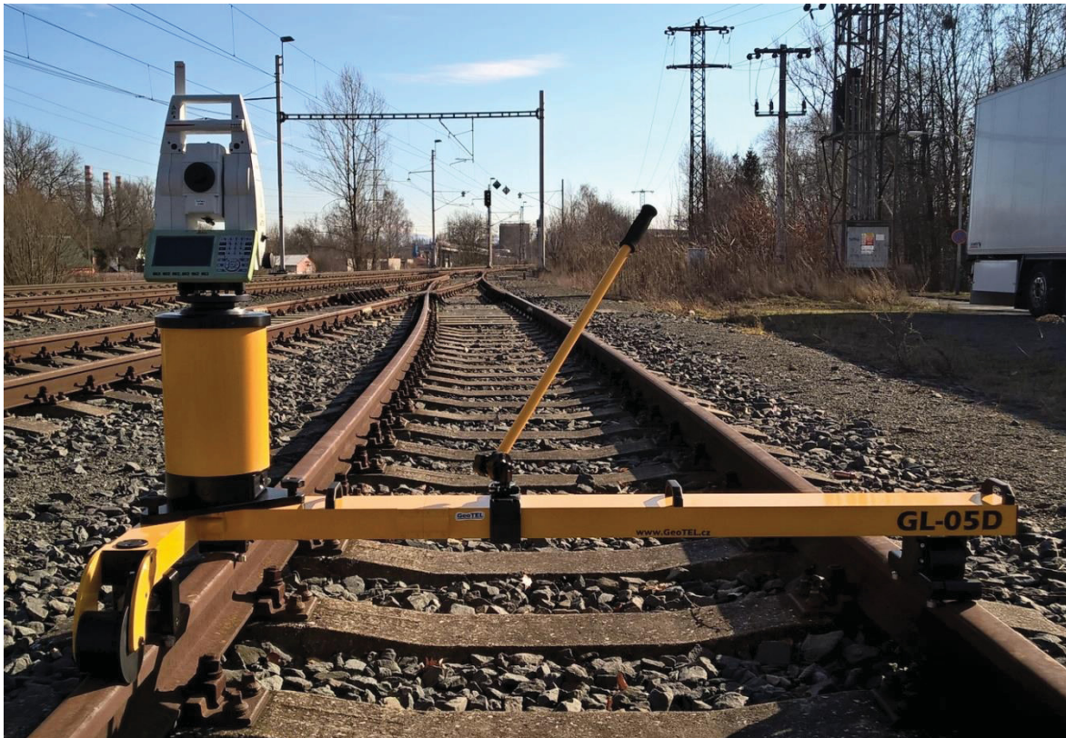
Obr. 2 Automatizovaný merací systém GeoTel GL-05D
